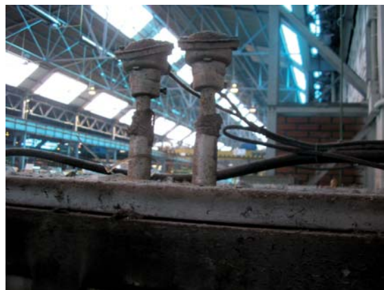
Figura A1.36 Aislamientos eléctricos en un horno
