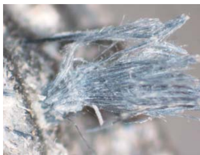
Figura A1.4 Material con amianto CROCIDOLITA (60 X)
