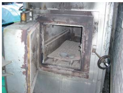
Figura A1.32 Junta textil en un horno
