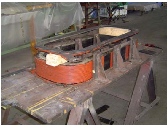
Figura A1.35 Aislamientos eléctricos en una bobina
