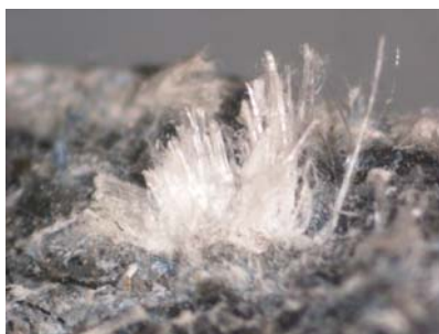
Figura A1.3 Material con amianto CRISOTILO (60 X)
