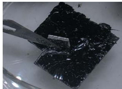
Figura A1.9 Material NO FRIABLE (tela asfáltica)
