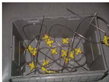
Figura A3.16 a Figura A3.16 b Sistema de humectación por inyección, diseñado para humectar materiales friables en profundidad y detalle de aplicación
