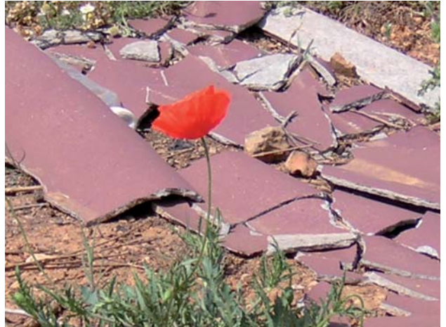
Figura A3.27b Residuos incontrolados de fibrocemento
