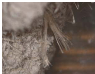
Figura A1.5 Material con amianto AMOSITA (60 X)
